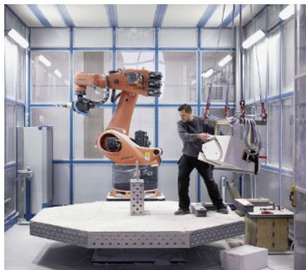
Drehen des Werkstücks am Fräsroboter. Das Schiebedach hat sich für den Kran geöffnet
