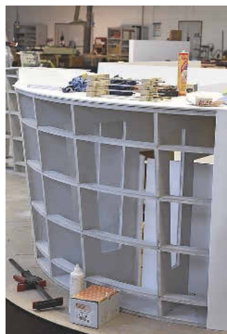
Die passgenau geschlitzten »Spanten« werden zusammen-gesteckt und verklebt
