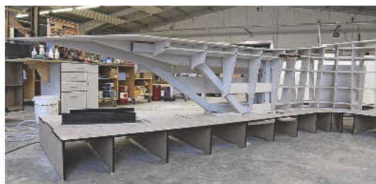
Stahlrohre mit Rechteck-Querschnitt stützen das auskragende Ende der Servicetheke
